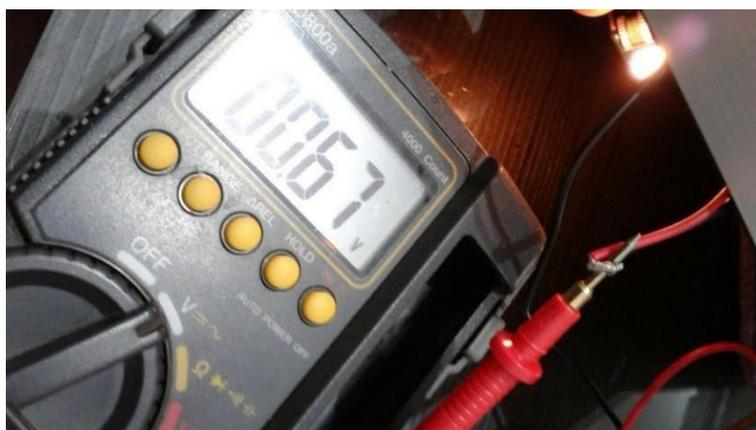
Gambar 4.3 Pengukuran tegangan pada output TEG.
