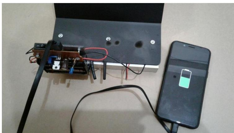
Gambar 4.6 Pengujian saat mengisi batere ponsel.
