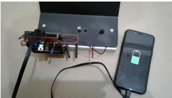
Gambar 4.3. Pengujian saat mengisi batere ponsel
