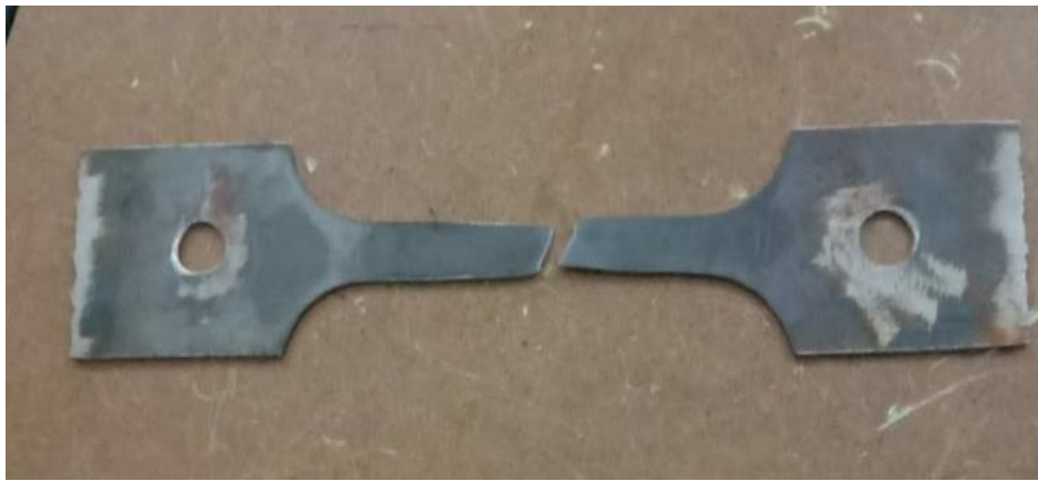
Gambar 4.2 Spesimen sesudah dilakukan pengujian tarik pada gambar 4.2 diatas merupakan gambar spesimen uji tarik yang sudah dilakukan pengujian eksperimen dengan mesin uji tarik menggunakan TYPE UTM-LC05T dengan Capasitas : 5000 kgf.
