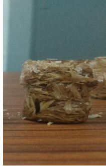
Gambar 4.9 Hasil pengujian tekan 90 gram Resin : 10 gram Sekam Padi
