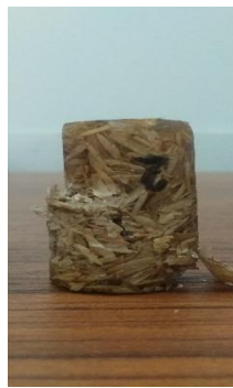
Gambar 4,10 Hasil pengujian tekan 80 gram Resin : 20 gram Sekam Padi
