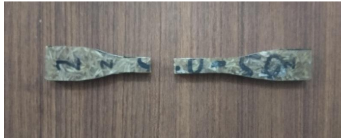
Gambar 4.3 Hasil Pengujian Tarik 50 gram Resi : 50 gram Sekam Padi
