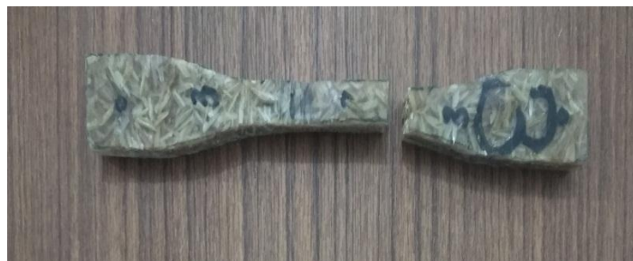
Gambar 4.4 Hasil Pengujian Tarik 25 gram Resin : 75 gram Sekam Padi
