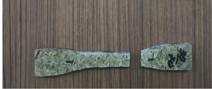
Gambar 4.2 Hasil Pengujian Tarik 70 gram Resi : 30 Gram Sekam Padi
