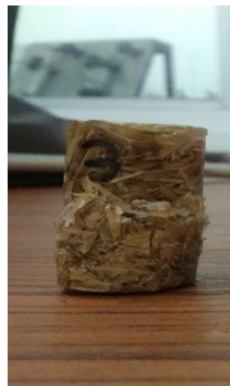
Gambar 4,11 Hasil pengujian tekan 70 gram Resin : 30 gram Sekam Padi
