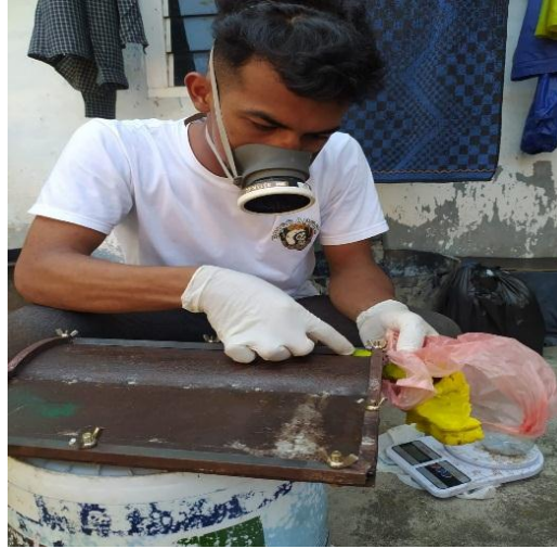
Gambar 3.32 Pemberian Plastisin Pada Cetakan Atap
