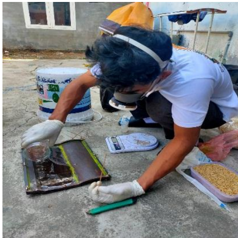
Gambar 3.35 Penuangan Resin Kedalam Cetakan Atap
