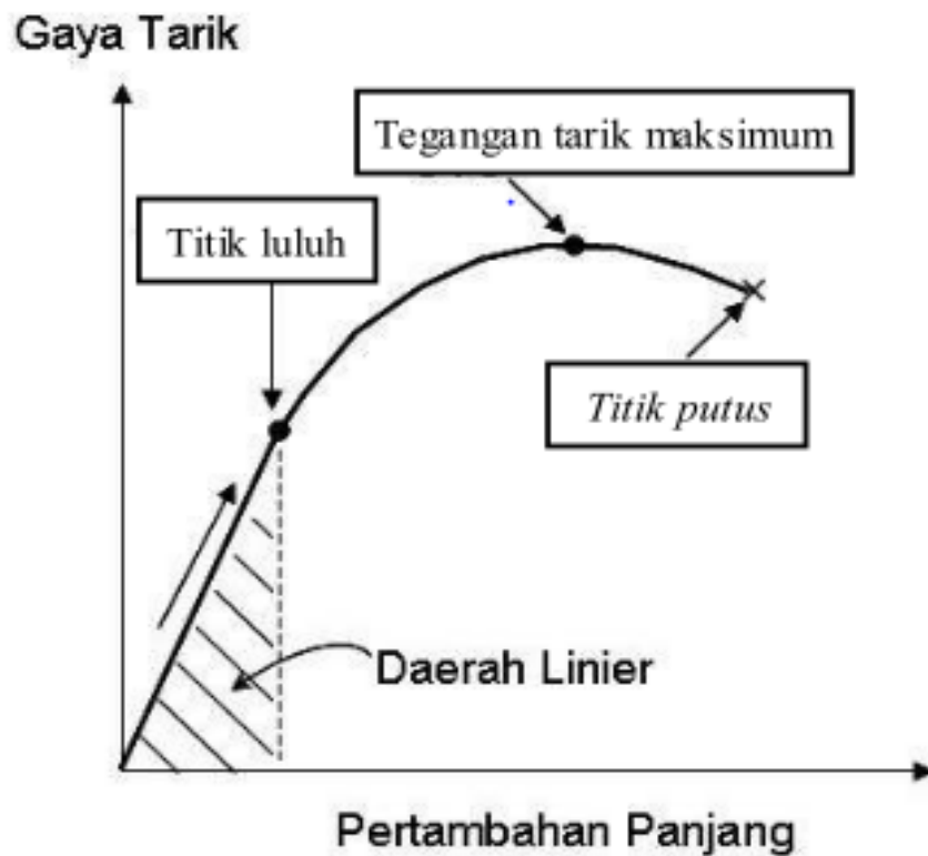
Gambar 2.18 Skema uji tarik (Sastranegara, 2009)
