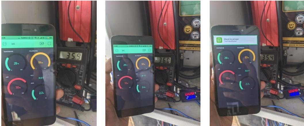
Gambar 6. Pengukuran akurasi sensor Tegangan
