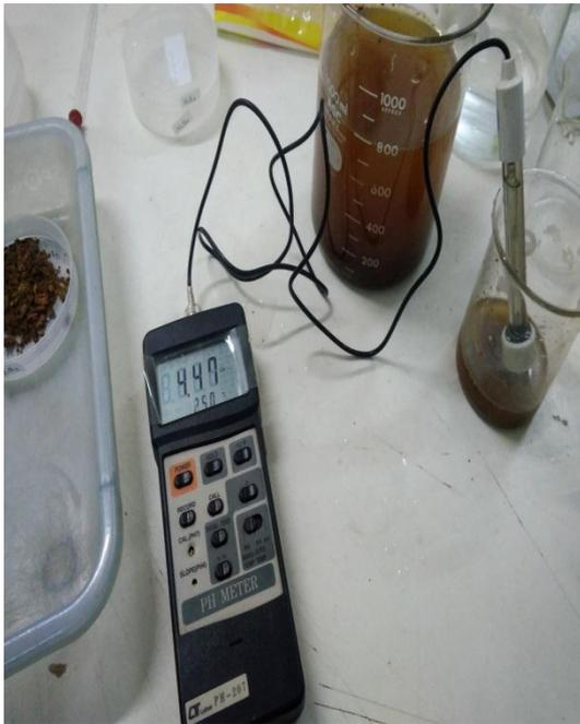
Gambar 18. Pengujian pH
