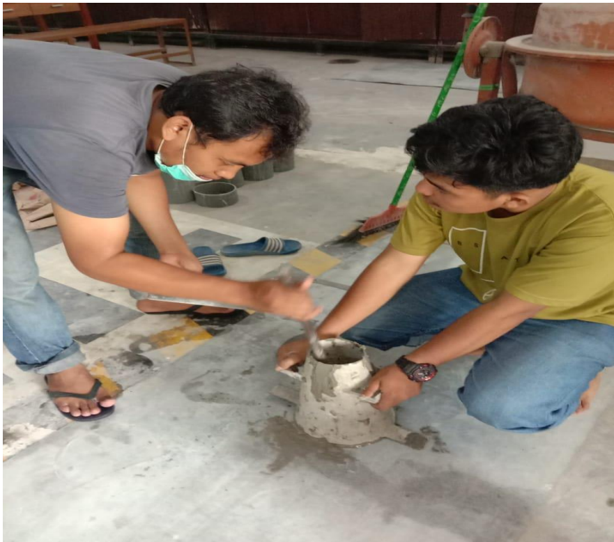
Gambar L14: Dokumentasi Slump test
