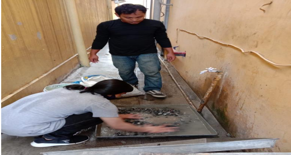
Gambar L1: Dokumentasi Pencucian agregat kasar
