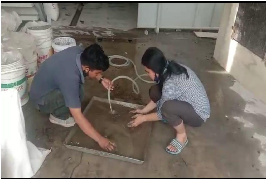
Gambar L2: Dokumentasi Pencucian agregat halus
