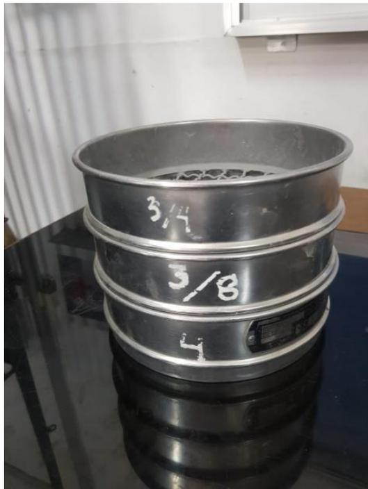
Gambar L-2: *Saringan Agregat Kasar.*
