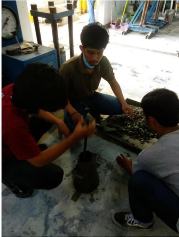
Gambar L-19: Proses Pengujian *Slump Flow*.
