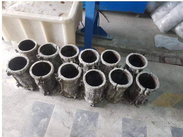
Gambar L-4: Cetakan Silinder.
