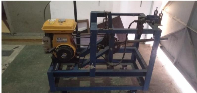
Gambar 3.5. Brake Dynamometer
