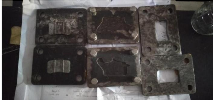
Gambar 3.2. Cetakan atau mal
