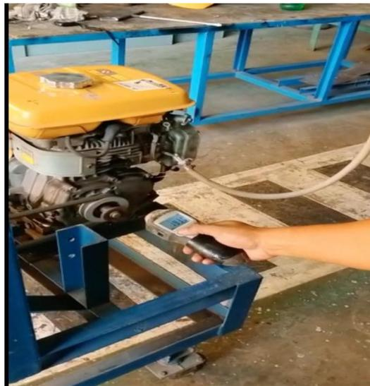
Gambar 2.29. Mengukur Rotasi Mesin Menggunakan Tachometer
