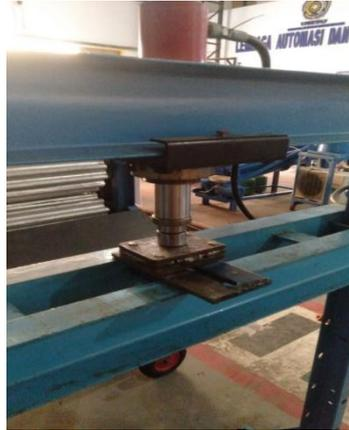
Gambar 3.24. Proses Kompaksi Atau Penekanan
