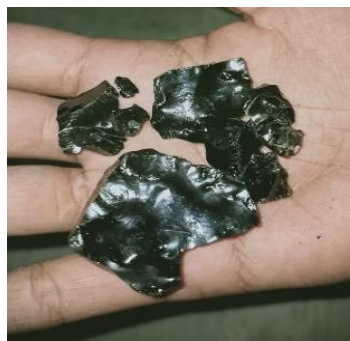
Gambar 3.8 : Proses pembuatan plastik PET menyerupai agregat kasar.
