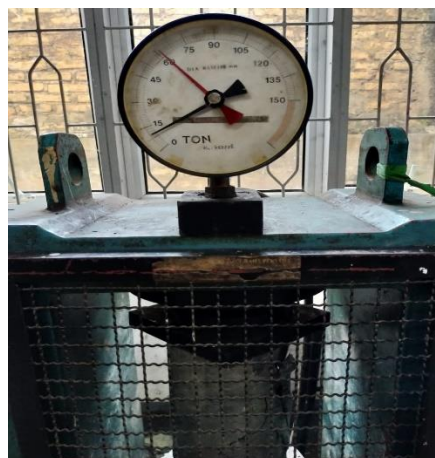
Lampiran 37 : Proses Pengujian Kuat Tekan Beton.
