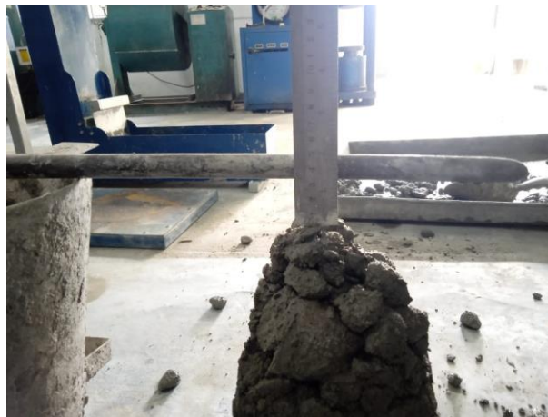
Lampiran 29 : Proses Pengujian Slump Test .
