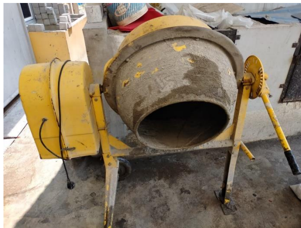
Lampiran 14 : Mixer Beton.
