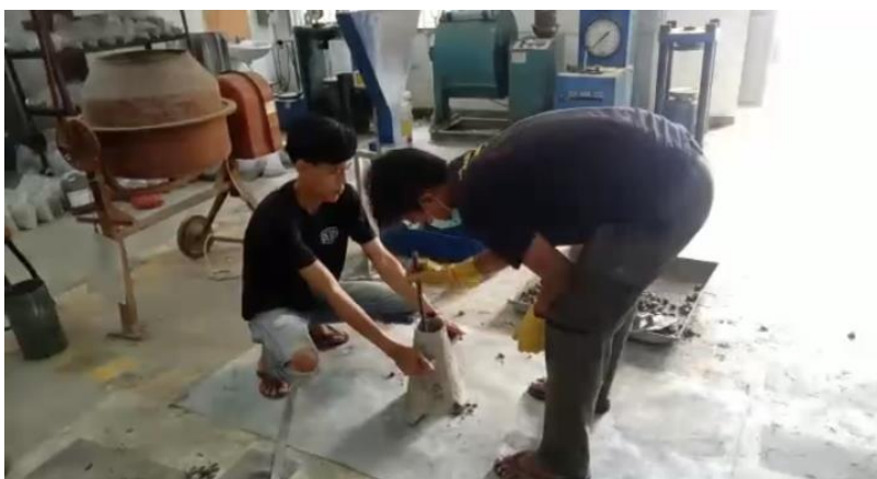
Lampiran 30 : Proses Perojokan Adukan Beton Di Cetakan.
