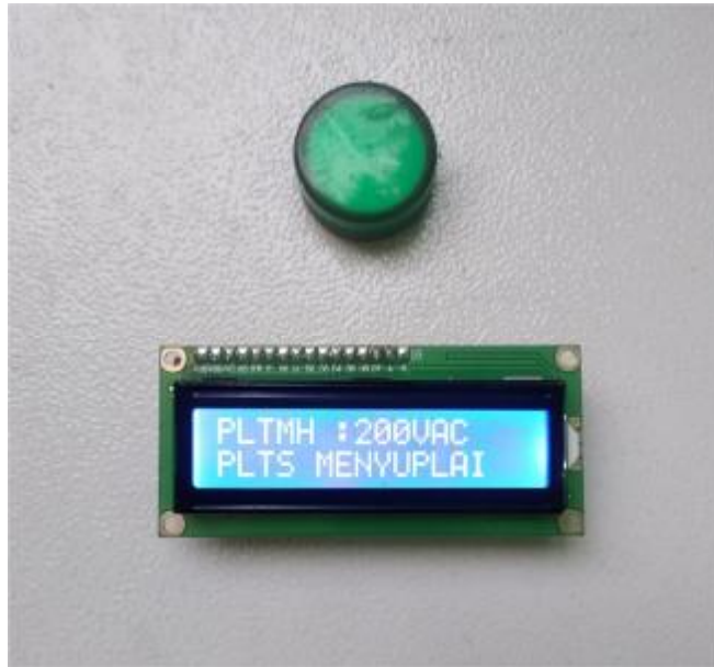
Gambar 4.3 LCD Menunjukkan PLTMH Drop tegangan
