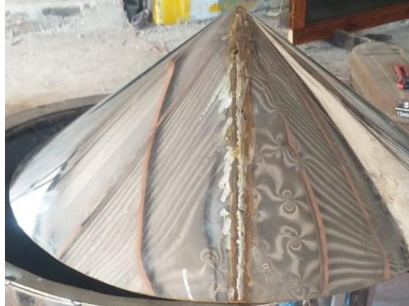
Gambar 4.11 Hasil pengelasan tutup ketel
