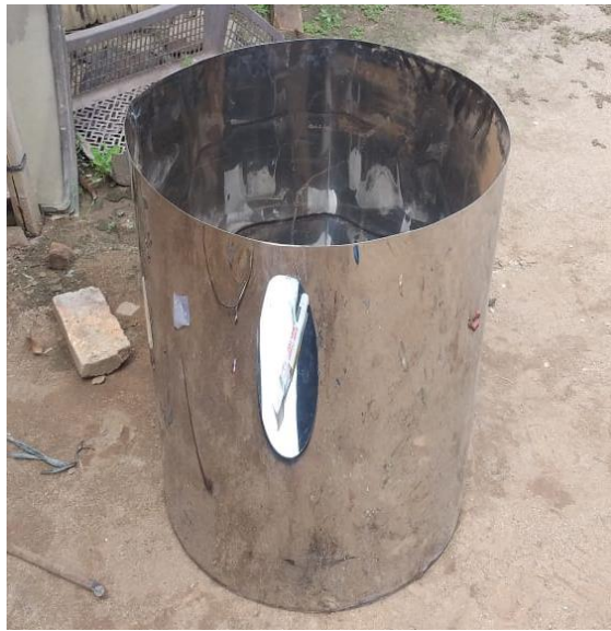
Gambar 4.7 Hasil pengelasan Tabung
