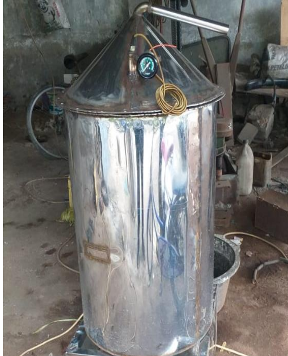
Gambar 4.17 Hasil dari pembuatan tabung ketel pada alat penyulingan minyak atsiri
