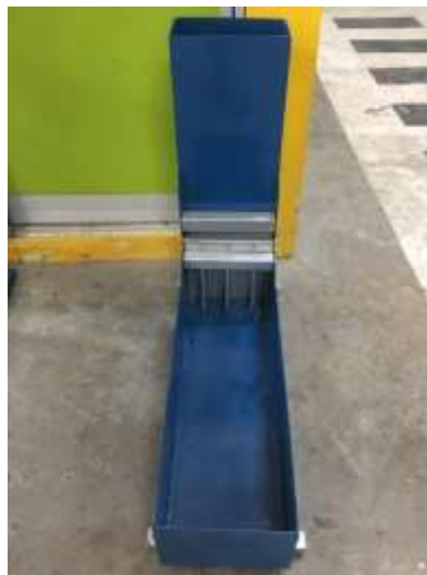
Gambar 3.5: Alat uji L-Box.
