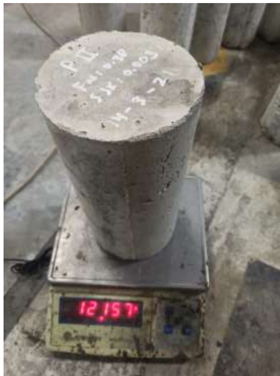
Gambar L.8: Menimbang Berat Beton Setelah Perendaman
