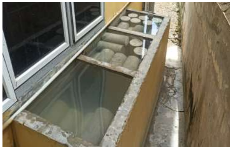
Gambar 3.6: Perawatan benda uji.
