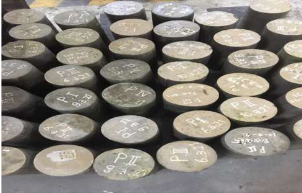
Gambar L.7: Mengeluarkan Beton yang Sudah Direndam Selama 28 Hari
