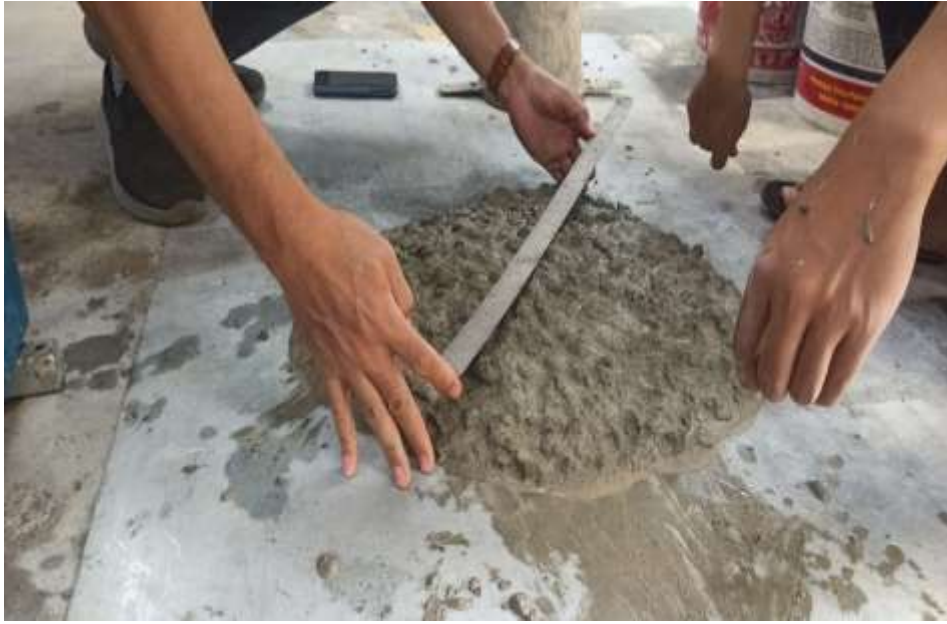
Gambar L.3: Melakukan Slump Flow Test pada Beton Segar
