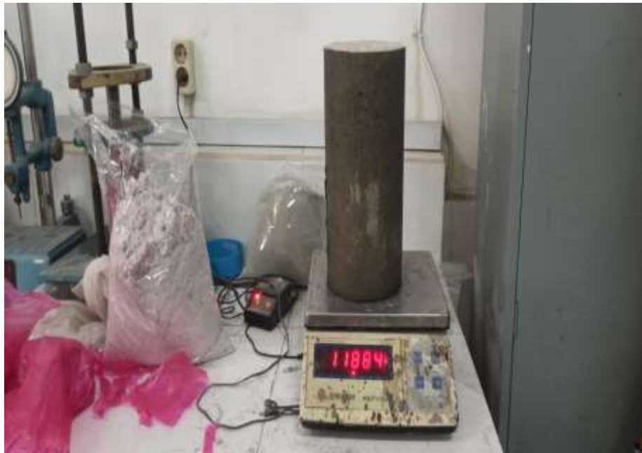
Gambar L.5: Menimbang Benda Uji Sebelum Perendam
