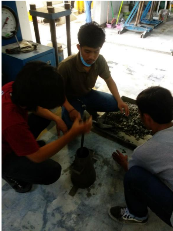
Gambar L-19: Proses Pengujian Slump Flow .
