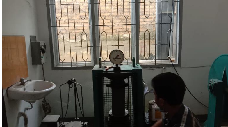
Gambar L.22: Pengujian kuat tekan.
