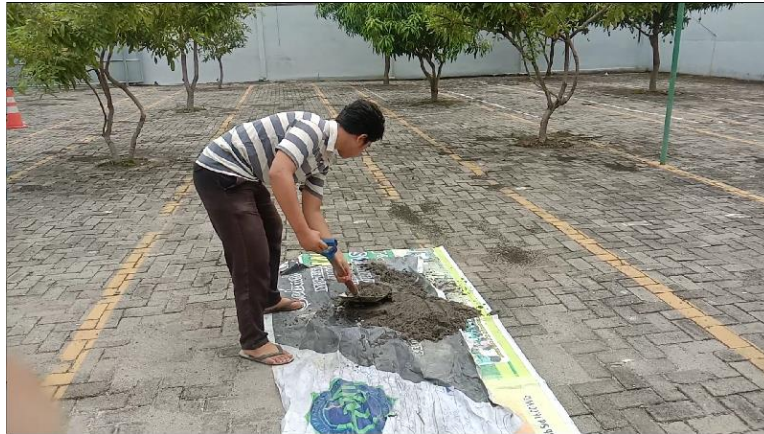
Gambar L.2: Mengeringkan agregat halus.
