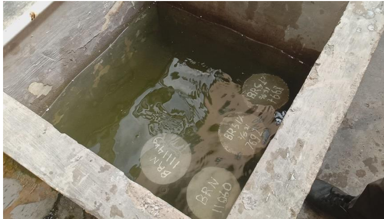
Gambar L.19: Perendaman beton ringan.
