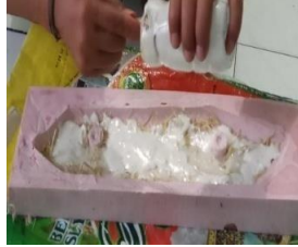
Gambar 2.10. Menuangkan kembali resin ke cetakan
