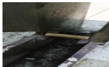
Gambar 3.20. Proses pengujian spesimen impact
