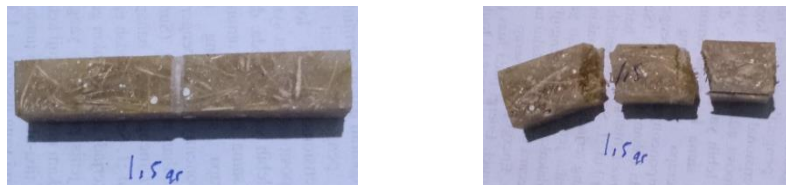
Gambar 4.10. Spesimen sebelum diuji dan Spesimen setelah diuji
