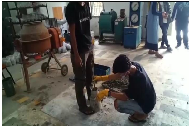
Lampiran 30. Proses Perojokan Adukan Beton
