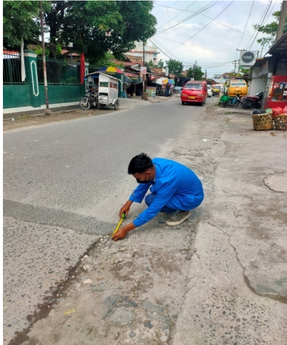
Gambar L.5 Mengukur dimensi Speed Bump di depan SMA Cerdas Murni, Jl. Beringin Pasar VII Tembung.
