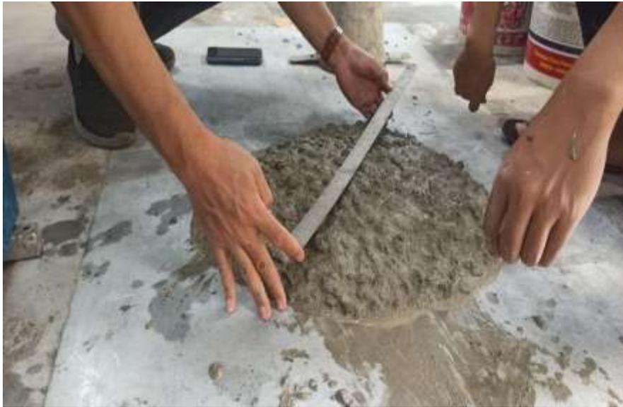
Gambar L.3 Melakukan *Slump Flow Test* pada Beton Segar
