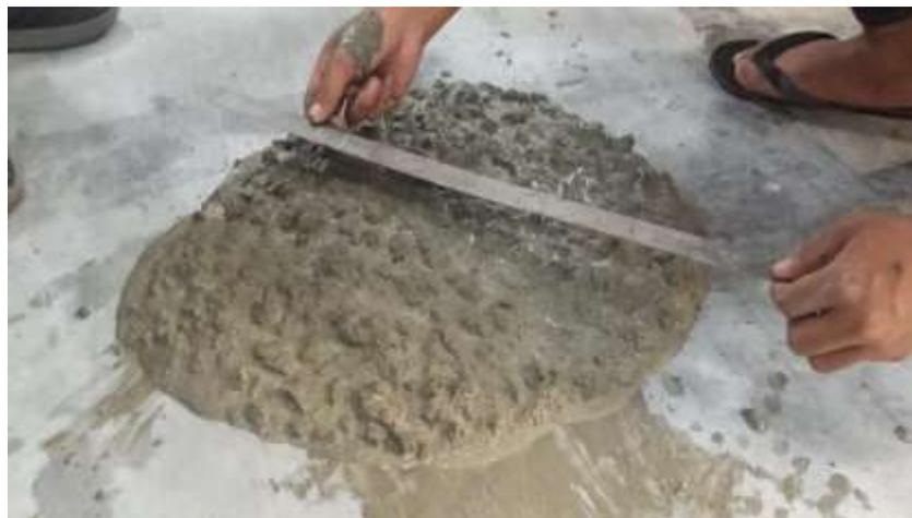
Gambar 3.3 Pengujian *slumpflow*
