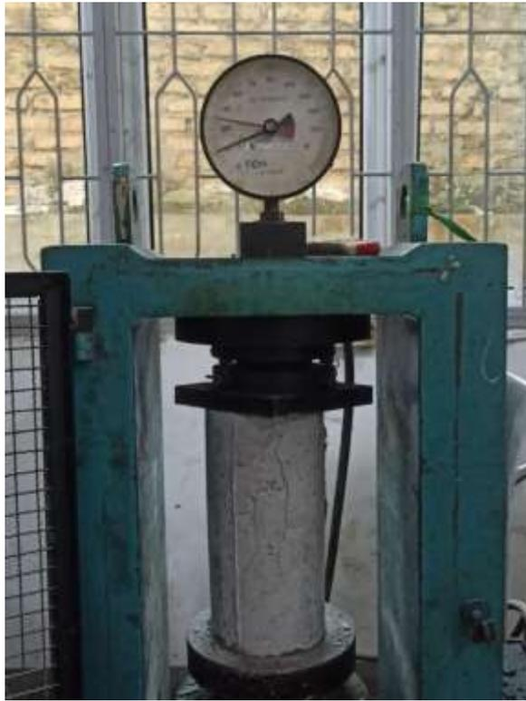
Gambar L.9 Pengujian Kuat Tekan Beton
