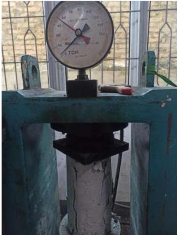
Gambar 3.5 Pengujian kuat tekan beton
