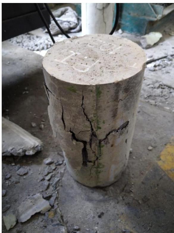
Gambar L.14 Beton Setelah Pengujian Kuat Tekan
