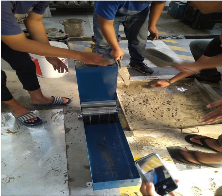
Gambar L.3 Melakukan Pengujian *Passing Ability*
