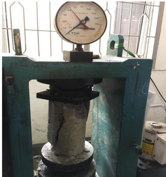
**Gambar 3.6** Pengujian kuat tekan beton
