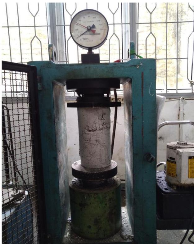
Gambar L.13 Pengujian Kuat Tekan Beton
