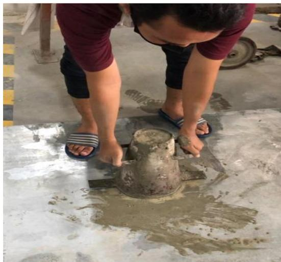
Gambar 3.3 Pengujian *slumpflow*
