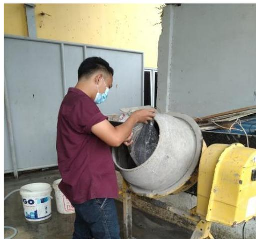
Gambar 3.2 Pembuatan benda uji
