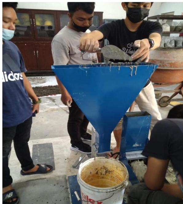
Gambar L.2 Melakukan Pengujian *V Funnel Test*
