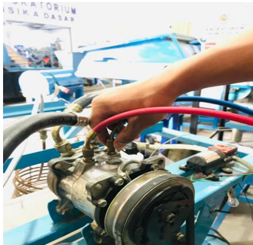
Gambar 4. 13. Memasang Selang Manifold
