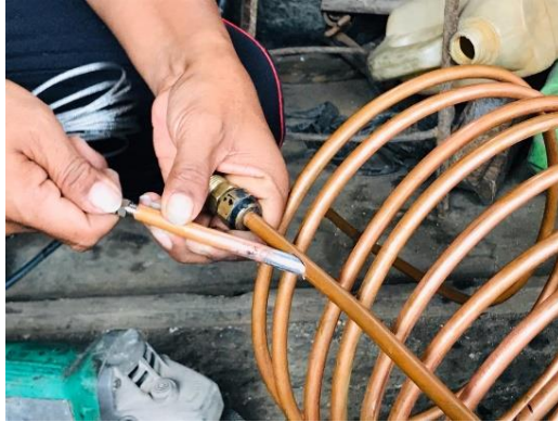
Gambar 4. 3. Menyambung Dudukan Sensor Ke Bahan
