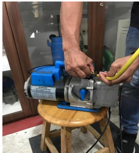
Gambar 4. 14. Menyiapkan Pompa Vakum
