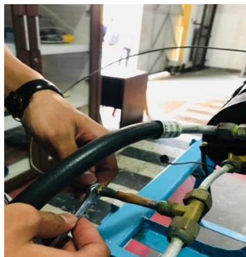
Gambar 4. 10. Pemasangan Sensor Dari Driyer Ke Evaporator
