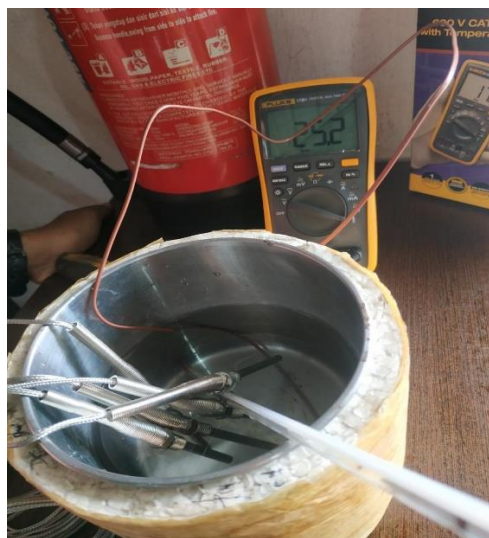
Gambar 2. 18. Kalibrasi Dengan Alat Ukur Digital Multimeter
