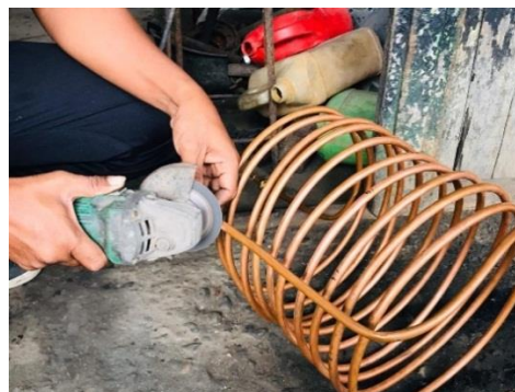
Gambar 4. 2. Membuat Lubang Dudukan Sensor
