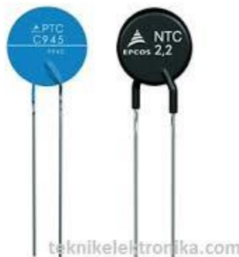
Gambar 2. 11. Sensor PTC dan Sensor NTC
