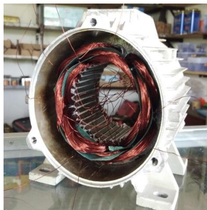
Gambar 4.8 Proses pemasangan prespan lapis.
