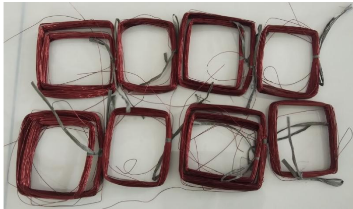
Gambar 4.5 Proses pengemalan kumparan.
