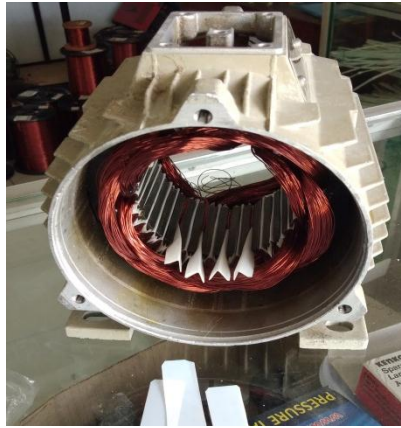
Gambar 4.7 Proses pemasangan prespan penutup.
