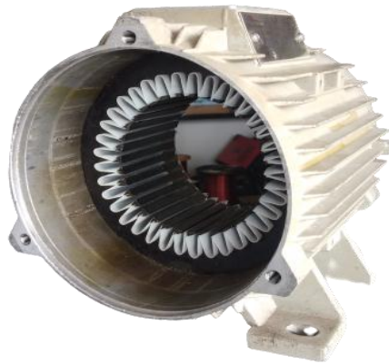
Gambar 4.4 Proses pemasangan prespan.
