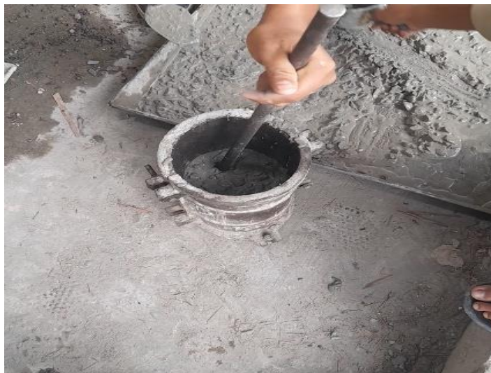
Gambar L-18 Perojokan Adukan Beton di Cetakan
