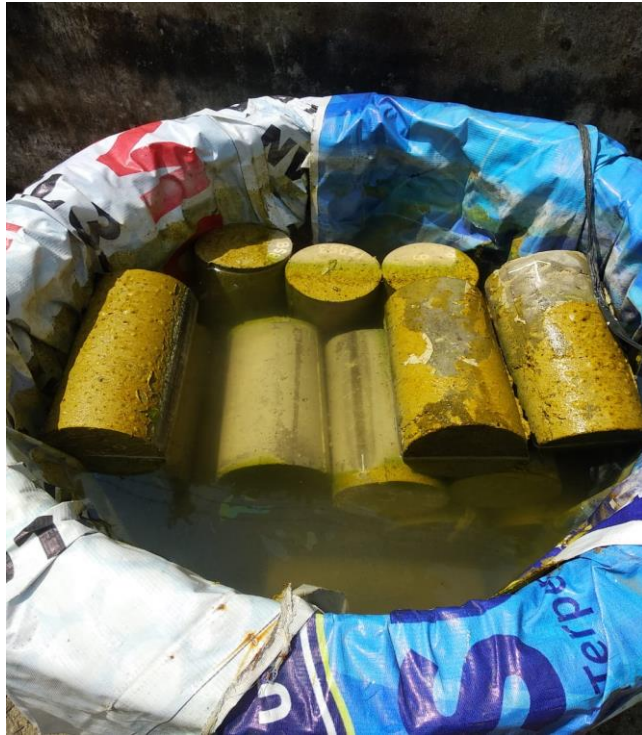
Gambar L-19 Perendaman Benda Uji
