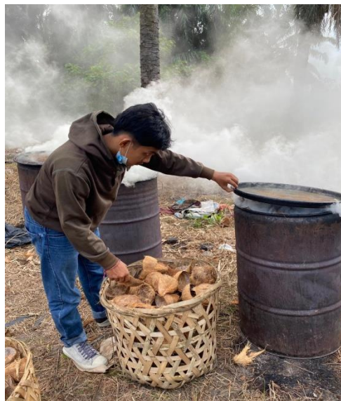
Gambar 2.1 Pembakaran Tempurung Kelapa
