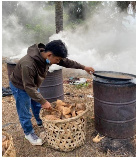
Gambar 3.8 Proses Pembakaran Batok Kelapa
