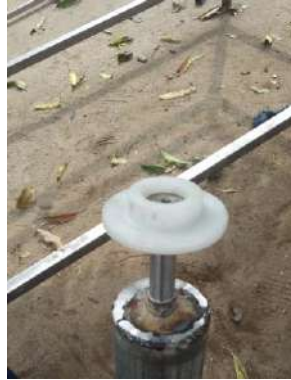
Gambar 4.52. Dudukan bearing dengan rol conveyor
