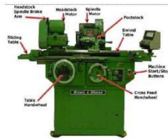
Gambar 2.11. Mesin Gerinda silindris (Teknik Permesinan Jilid 2 Kelas 10 Widarto, 2008)
