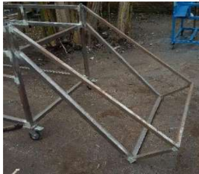
Gambar 4.18. Rancangan rangka bak penampung buah
