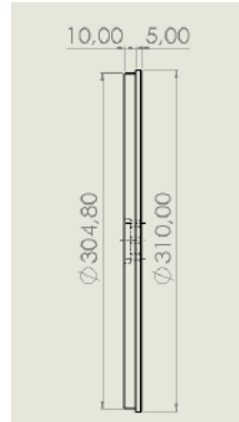
Gambar 4.57. Rancangan ukuran diameter luar
