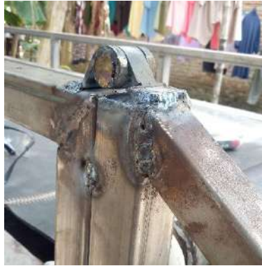
Gambar 4.17. Rancangan engsel kerangka mesin dengan kerangka bak penampung buah
