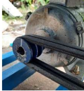
Gambar 4.90. Pully Motor listrik
