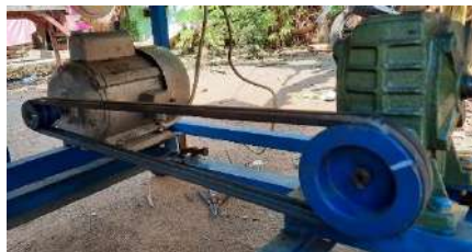
Gambar 4.109. Mesin motor dan gearbox diposisikan bersebelahan dan menggunakan pully
