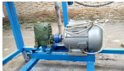
Gambar 4.108. Mesin motor dan gearbox yang dihubungkan dengan kopling dan diposisikan di kiri belakang mesin sortir
