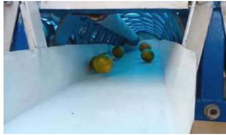
Gambar 4.110. Rancangan pipa galvanis berputar
