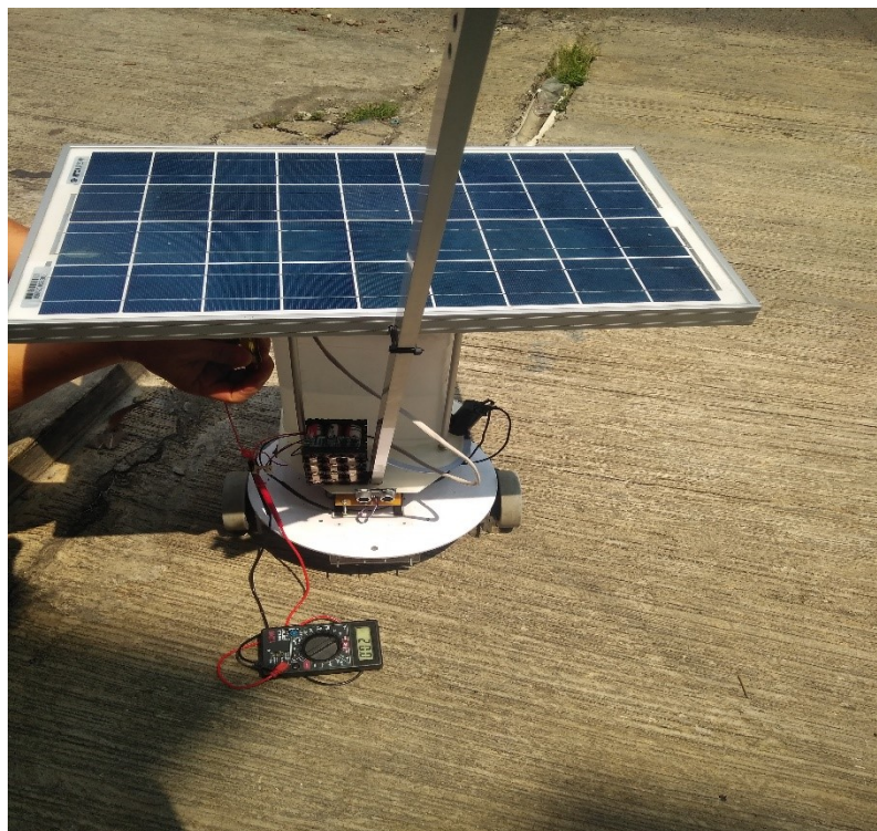
Gambar 4.6 Proses pengukuran tegangan panel surya
