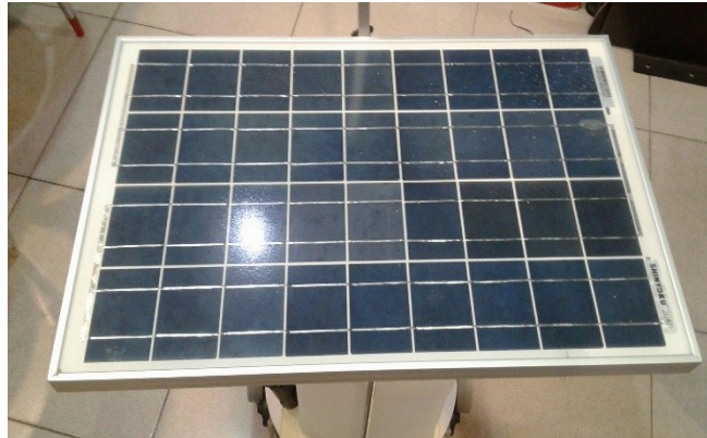
Gambar 4.2 Panel surya 20 watt yang digunakan untuk mensuplai robot
