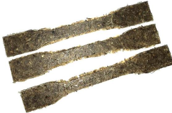
Gambar 4.1 Spesimen Uji Tarik
