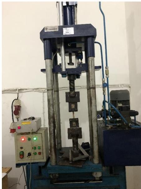
Gambar 2.12 Mesin Uji Tarik (*Universal Testing Machine*)
