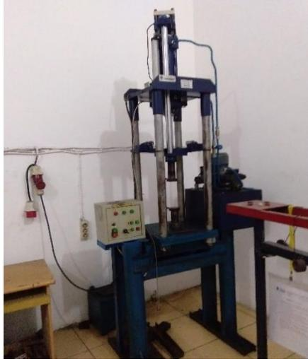
Gambar 4.6 Mesin Uji Tarik dan Kelengkapannya
