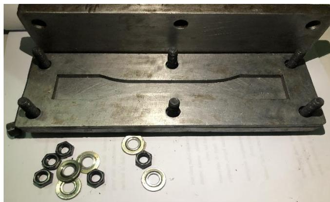
Gambar 3.2 Cetakan Spesimen Uji Tarik
