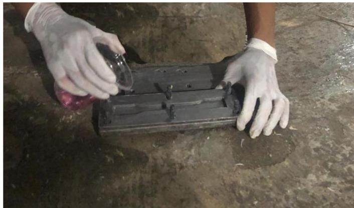
Gambar 4.4 Penuangan bahan kedalam cetakan
