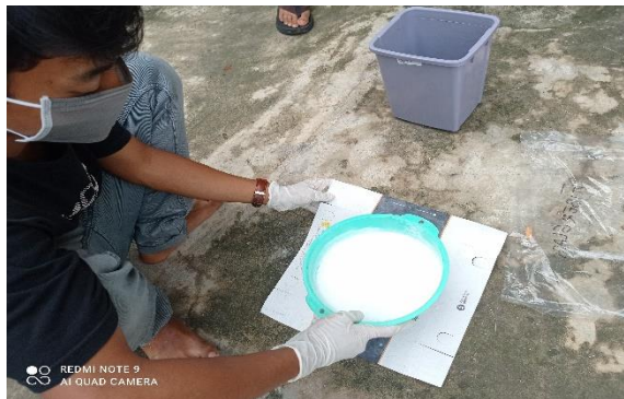
Gambar 4.6 Menyaring serbuk talk dan aerosil
