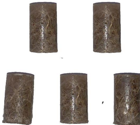
Gambar 4.2 Spesimen uji tekan
