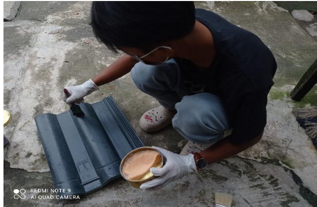
Gambar 4.8 Melapisi cetakan dengan wax
