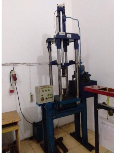
Gambar 4.12 Mesin Uji Tarik dan Kelengkapannya
