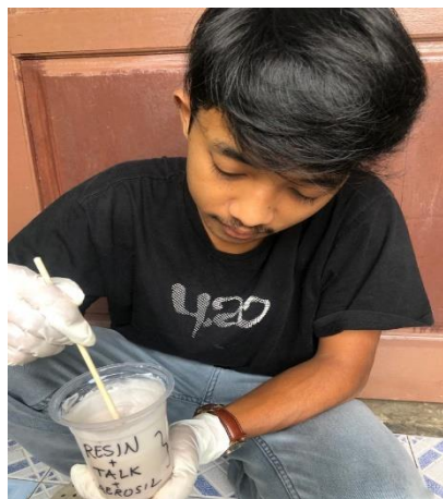
Gambar 4.9 Membuat adonan resin
