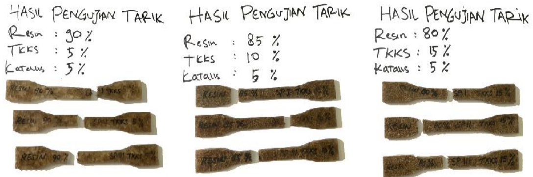
Gambar 4.17 Patahan Spesimen Hasil Pengujian Tarik
