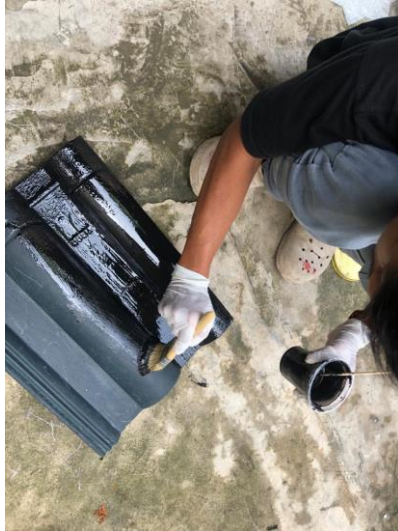
Gambar 4.10 Melapisi cetakan dengan adonan
