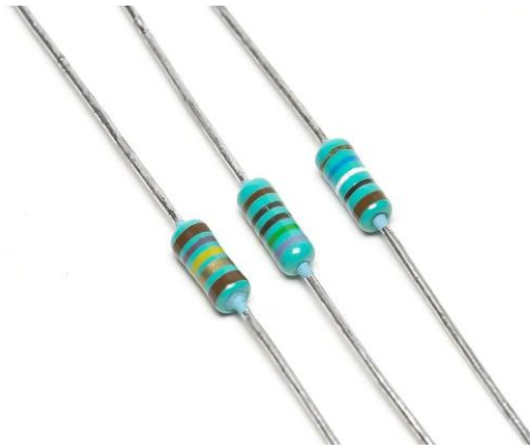
Gambar 2.13 Tiga buah resistor komposisi karbon.
