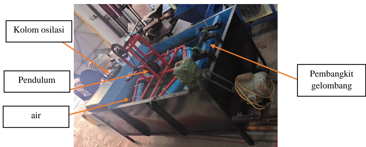
Gambar 4.16 Hasil Pembuatan Alat Uji Pembangkit Tenaga Gelombnag Air Menjadi Energi Listrik
