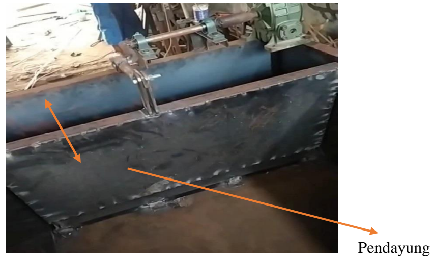
Gambar 4.4 Konsep Pembuatan Tenaga Gelombang Dengan Pendayung
