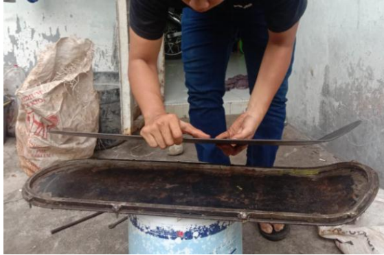
Gambar 4.3 Pemasangan antara cetakan tengah dan cetakan tutup
