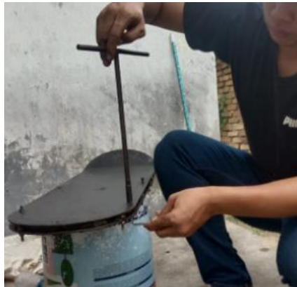
Gambar 4.4 Pemasangan baut dan mur antara cetakan tengah dan cetakan tutup
