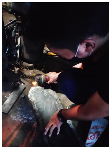
Gambar 3.26 Proses Pemotongan menggunakan gerinda
