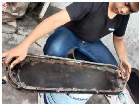
Gambar 4.1 Meyatukan cetakan dasar dan cetakan tengah
