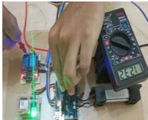
Gambar 4.28 Pengujian Relay Ke Kipas Pada Saat Posisi ON
