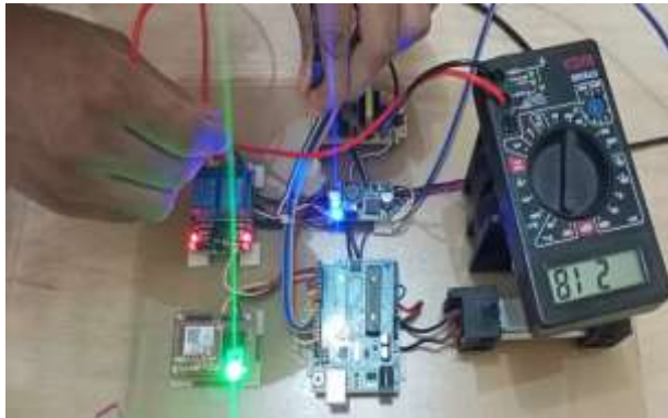
Gambar 4.30 Pengujian Relay Heater Pada Saat Posisi On
