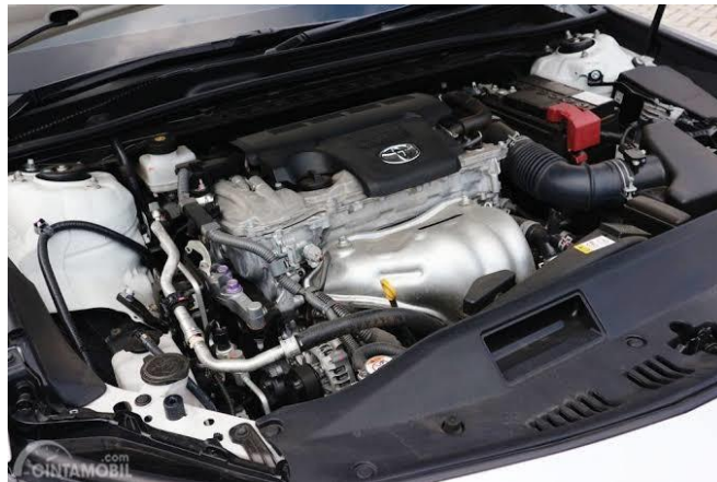
Gambar 3.2. Foto assembling dari mesin IL-4 DOHC VVT-i
