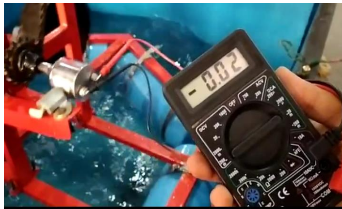
Gambar 4.56 Pengujian alat pembangkit listrik pada saat 45cm air pada kolam
