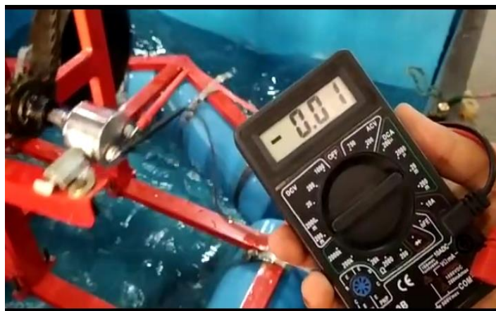
Gambar 4.54 Pengujian alat pembangkit listrik pada saat 30cm air pada kolam
