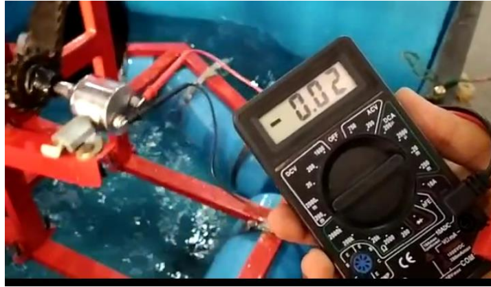
Gambar 4.55 Pengujian alat pembangkit listrik pada saat 40cm air pada kolam
