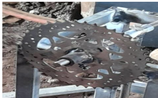
Gambar 4.34 pembuatan dudukan roda gigi
