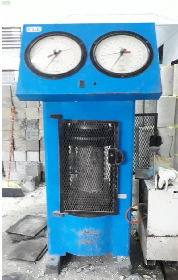
Gambar 12: Pengujian kuat tekan benda uji berbagai jenis variasi
