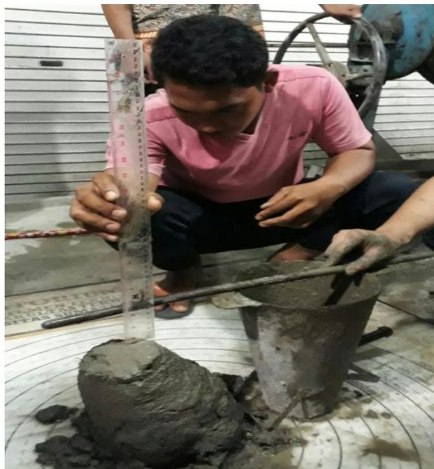
Gambar 8: Hasil pengujian nilai slump
