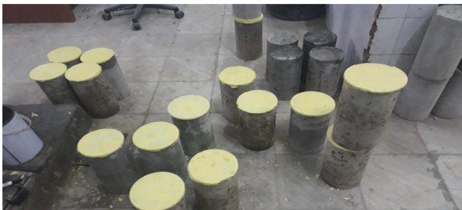
Gambar 11: Beberapa benda uji yang telah di ratakan permukaan (*capping*)
