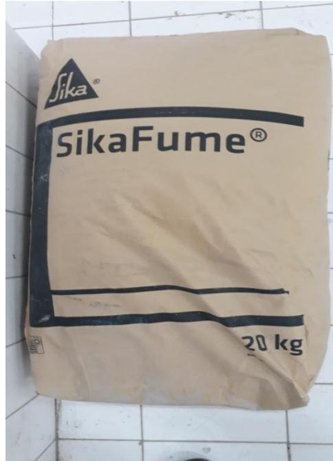
Gambar 5: Zat additive *SikaFume* yang akan digunakan dalam penelitian
