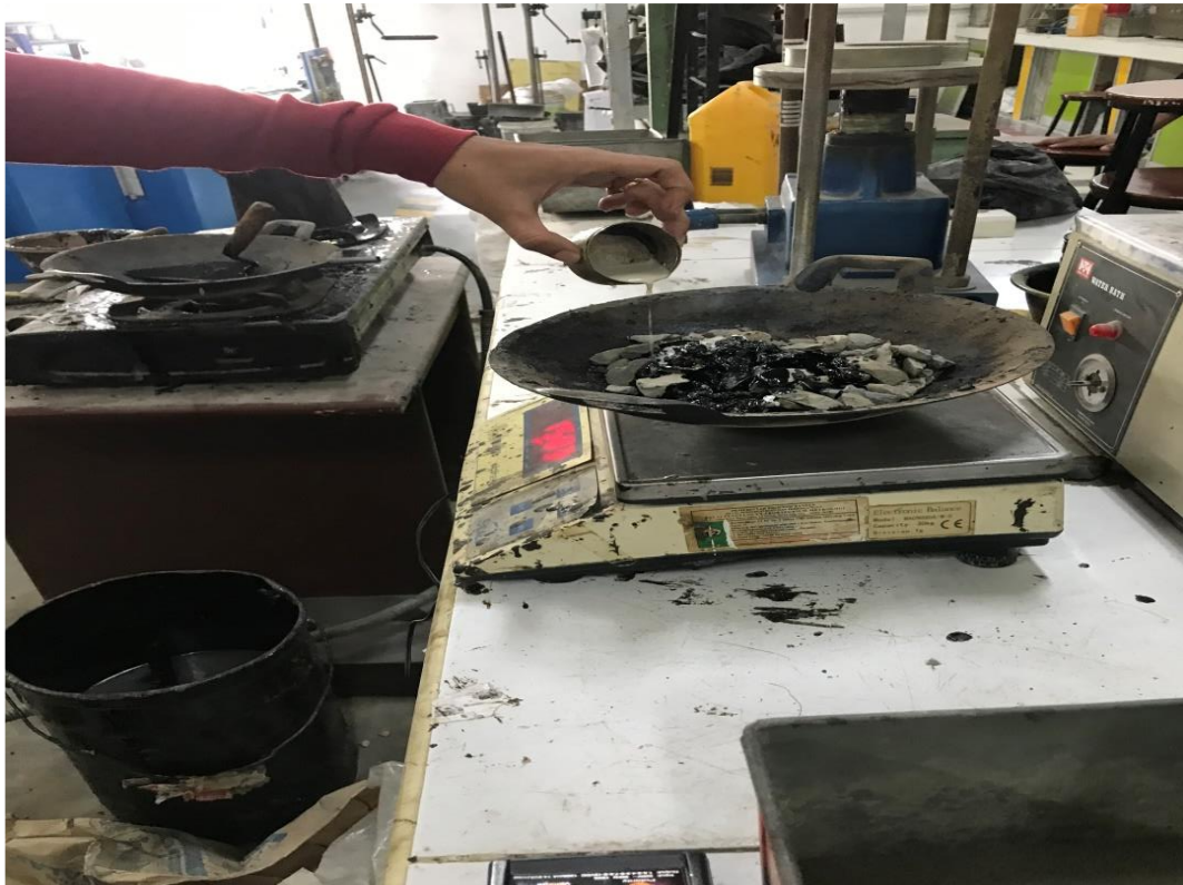
Gambar L.13: Pencampuran bahan tambah getah karet pada campuran beraspal.
