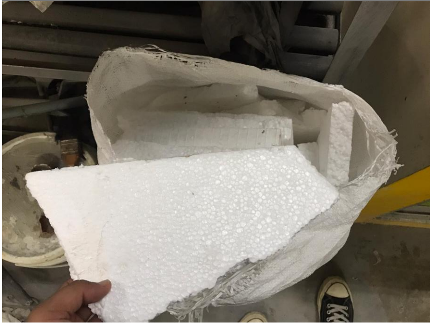
Gambar L.5: Syrofoam sebagai bahan substitusi aspal.
