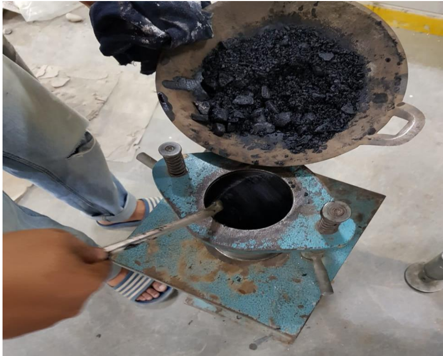
Gambar L.7: Proses memasukkan campuran kedalam cetakan.
