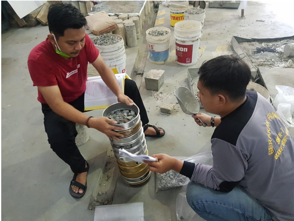
Gambar L.3: Proses analisa saringan.
