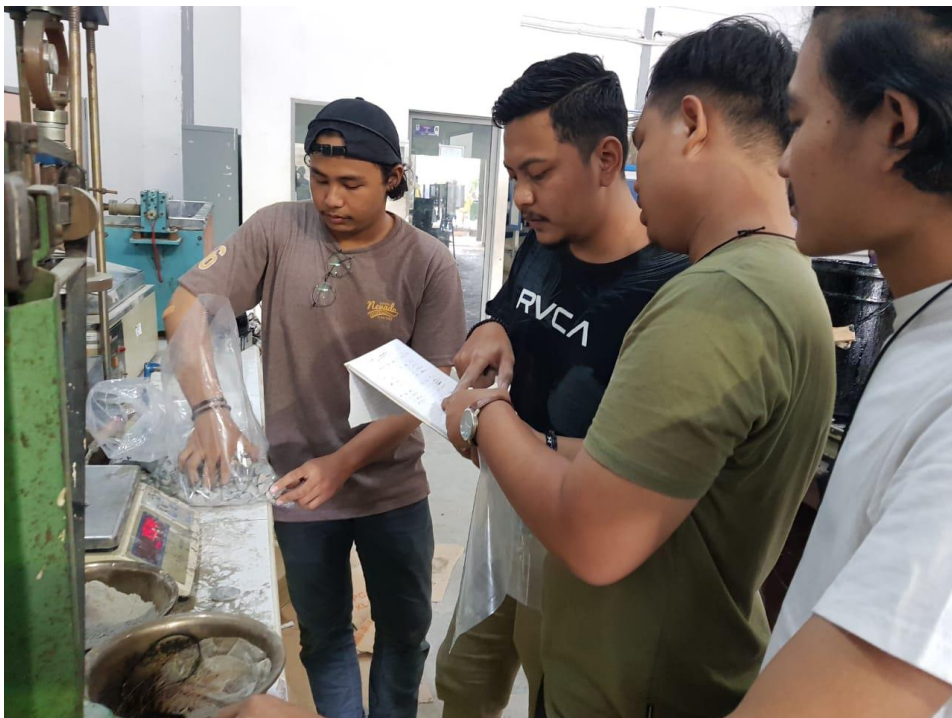
Gambar L.4: Proses menimbang agregat untuk proporsi campuran.
