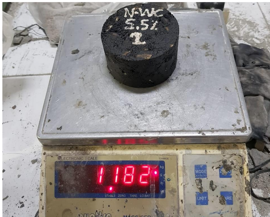
Gambar L.10: Proses penimbangan benda uji.
