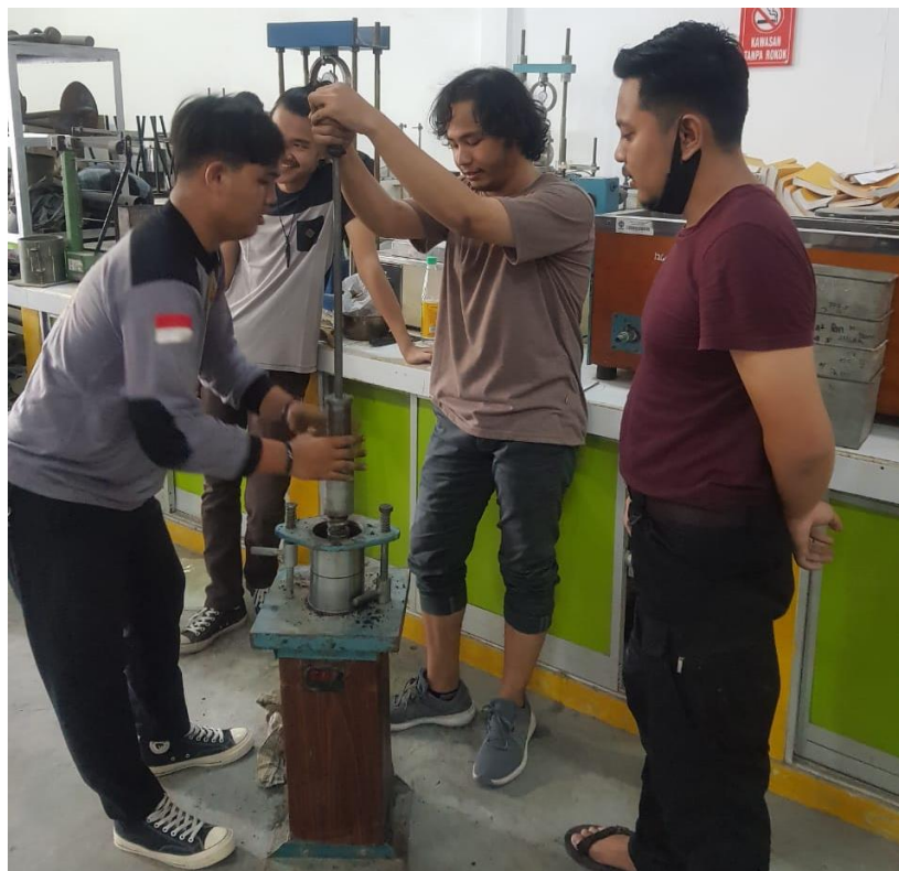
Gambar L.8: Proses pemadatan campuran.
