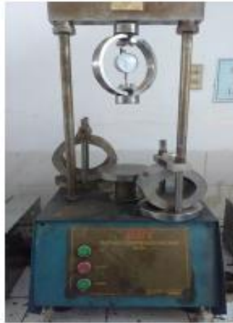
Gambar 2.1: Alat pengujian Marshall (Maulana, 2019).
