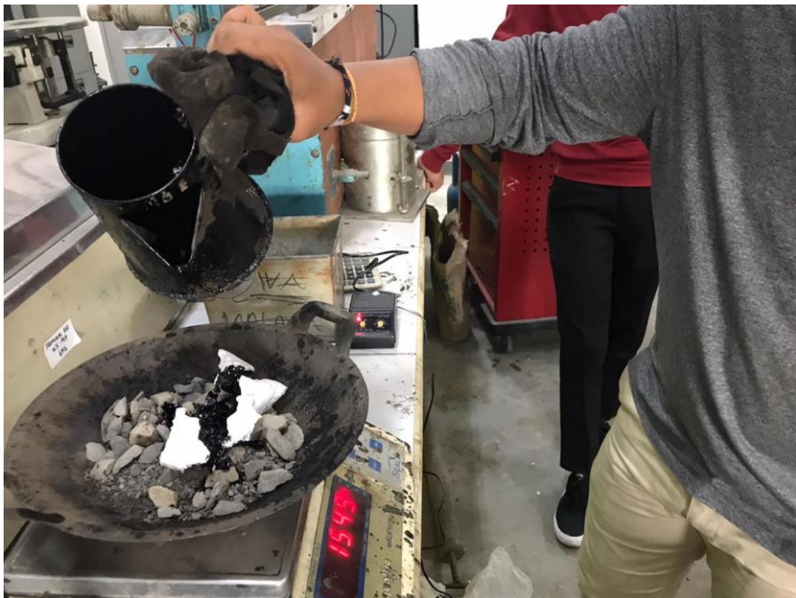
Gambar L.6: Syrofoam sebagai bahan substitusi aspal.
