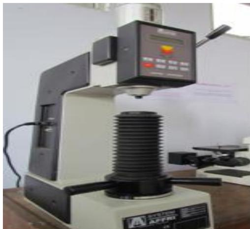
Gambar 3.9 Alat uji kekerasan
