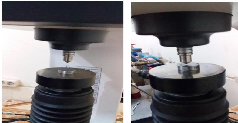
Gambar 3.24 Gambar Peletakan Spesimen Pada Mesin Uji *Hardness*
