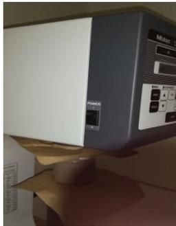
Tombol power berfungsi untuk menghidupkan mesin uji Rockwell
