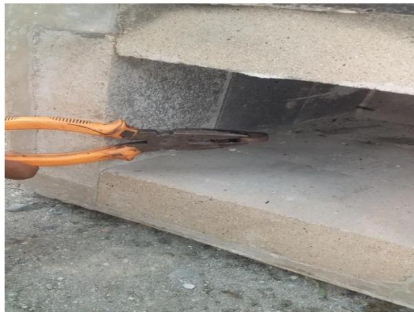
Gambar 3.17 Gambar memasukkan specimen pada tungku pemanas
