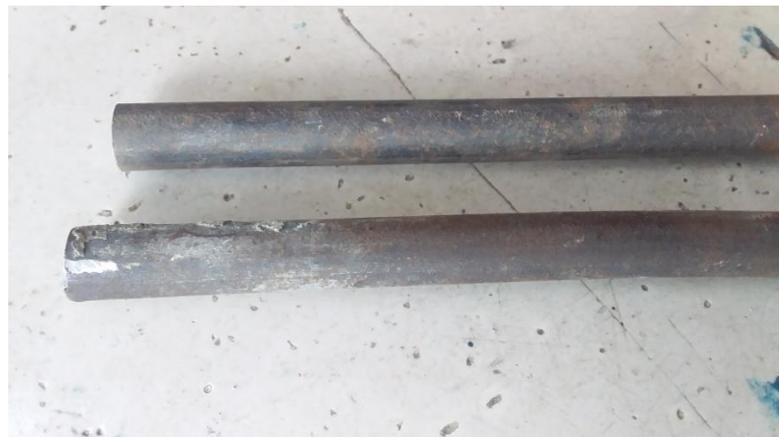
Gambar 3.11 Spesimen baja ST37
