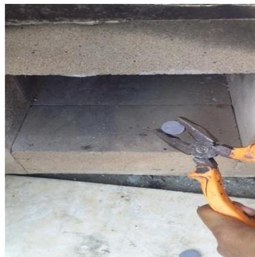
Gambar 3.19 Gambar Mengeluarkan Specimen Dari Dapur Pemanas
