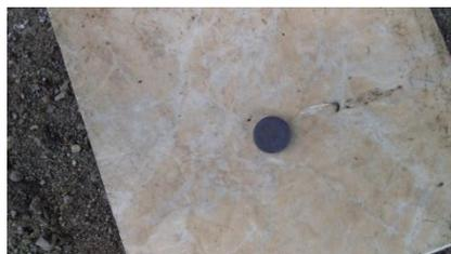
Gambar 3.20 Gaambar pendinginan specimen dengan udara
