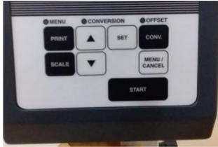
Tombol instrument berfungsi untuk menyetel skala-skala yang akan digunakan pada saat pengujian serta untuk memulai pengujian
