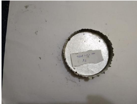
Gambar 4.5 Gambar hasil pengujian spesimen 2 dengan ketebalan 0,2 mm
