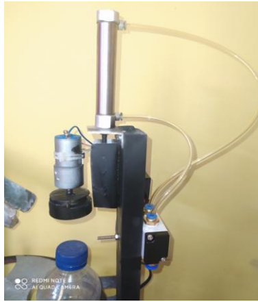
Gambar 3.4 Penguncian Dan Solenoid valve
