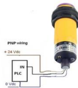
Gambar 4.2. Wiring Sensor Photoelektrik
