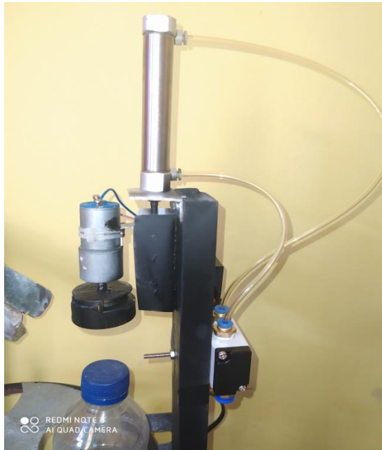
Gambar 3.4 Penguncian Dan Solenoid valve
