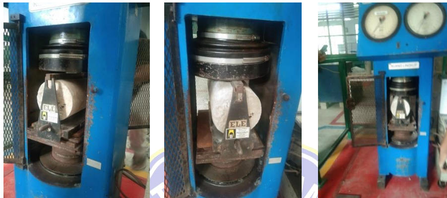
Gambar 4.1 Pengujian Kuat Tarik Belah Beton.
