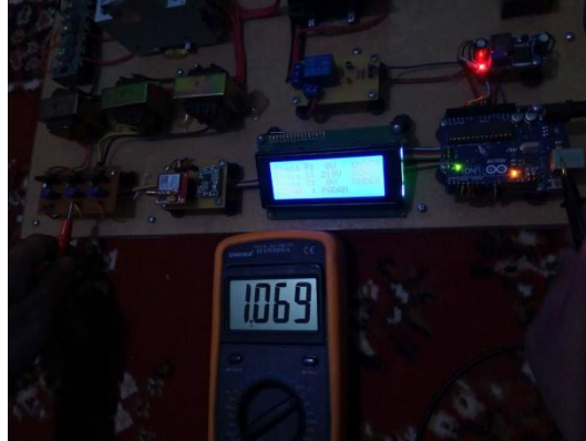
Gambar 4.18 Hasil Pengukuran Output Sensor Tegangan S
