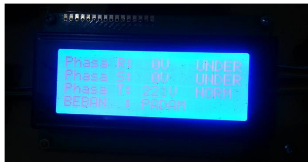
Gambar 4.21 Hasil Pengukuran Phase T pada LCD
