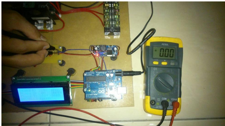
Gambar 4.11 Tegangan Input Relay Kondisi OFF
