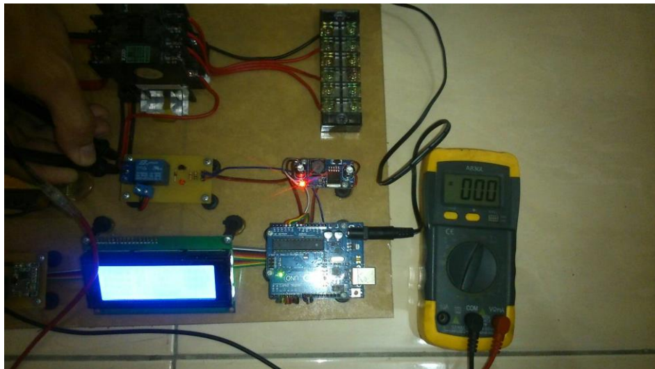
Gambar 4.13 Pengukuran Relay ke Kontaktor OFF
