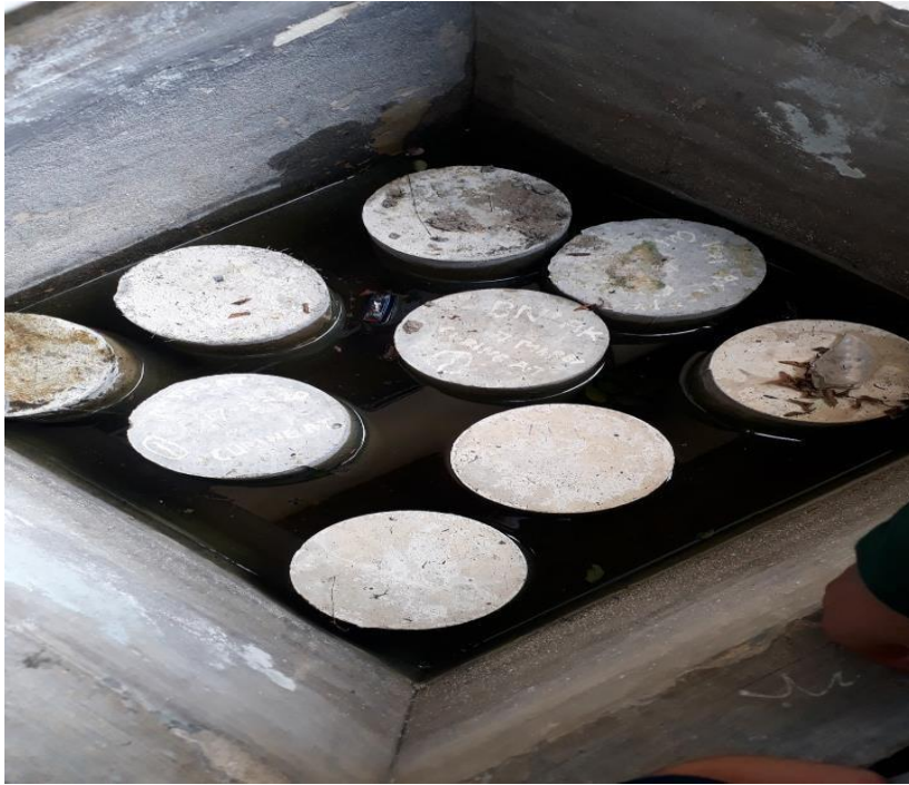
Gambar L7: Dokumentasi proses perawatan beton
