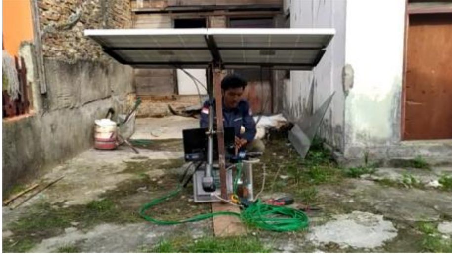
Gambar 3.8 Posisi panel mengarah ke matahari terbit
