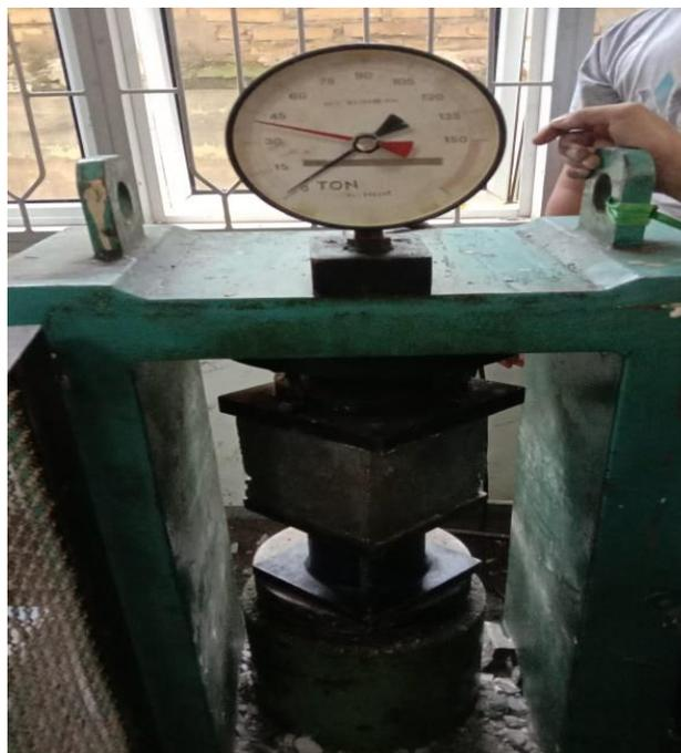
Gambar L9: Dokumentasi pengujian kuat tekan beton
