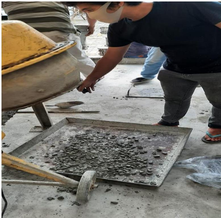
Gambar L4: Dokumentasi proses pengecoran pembuatan benda uji penelitian
