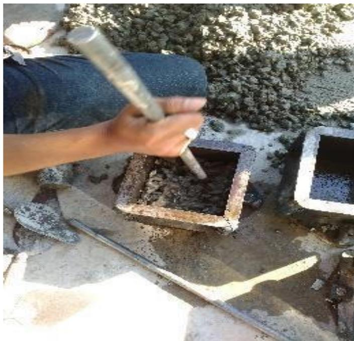
Gambar L6: Dokumentasi proses pencetakan benda uji penelitian
