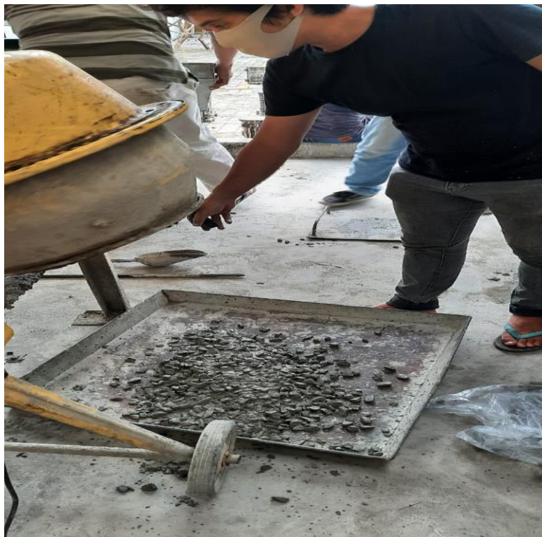
Gambar L4: Dokumentasi proses pengecoran pembuatan benda uji penelitian
