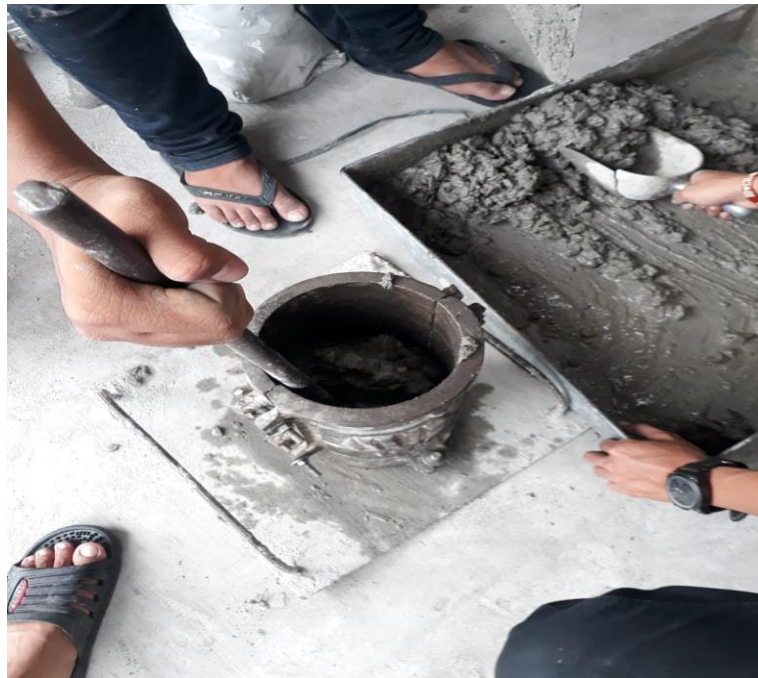
Gambar L6: Dokumentasi proses pencetakan benda uji penelitian
