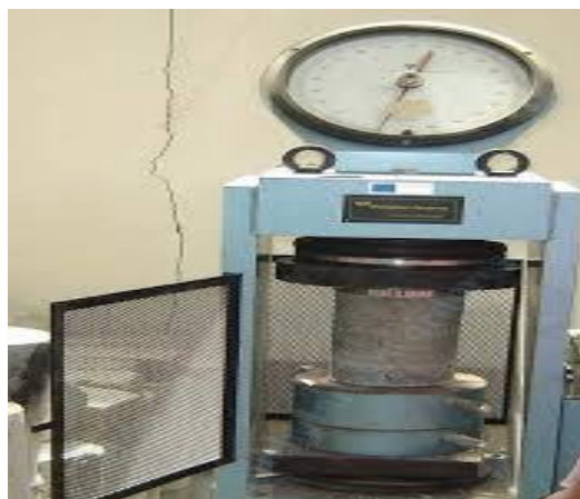
Gambar 4.5: Kuat tekan pada benda uji.
