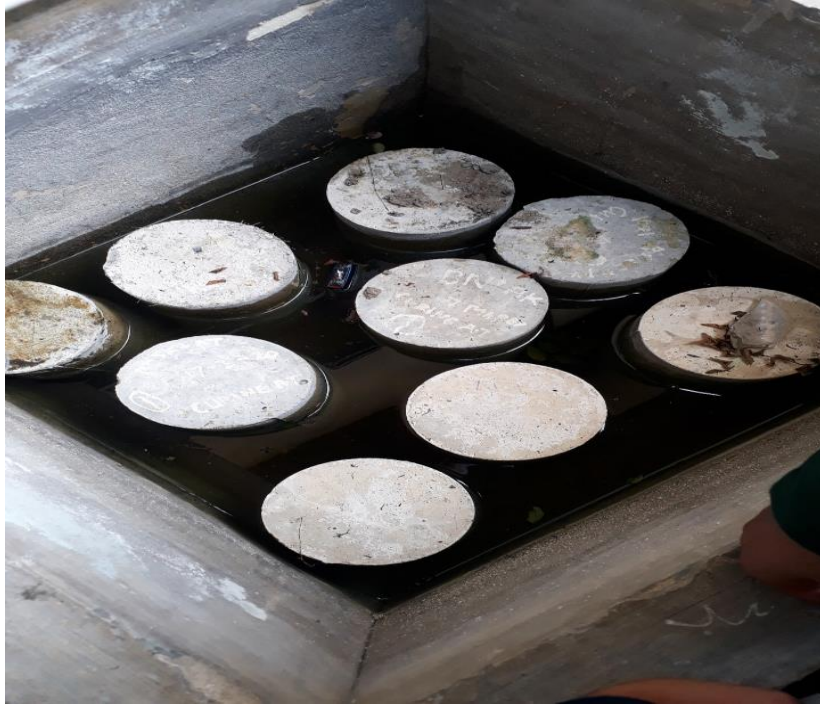
Gambar L7: Dokumentasi proses perendaman beton 28 hari
