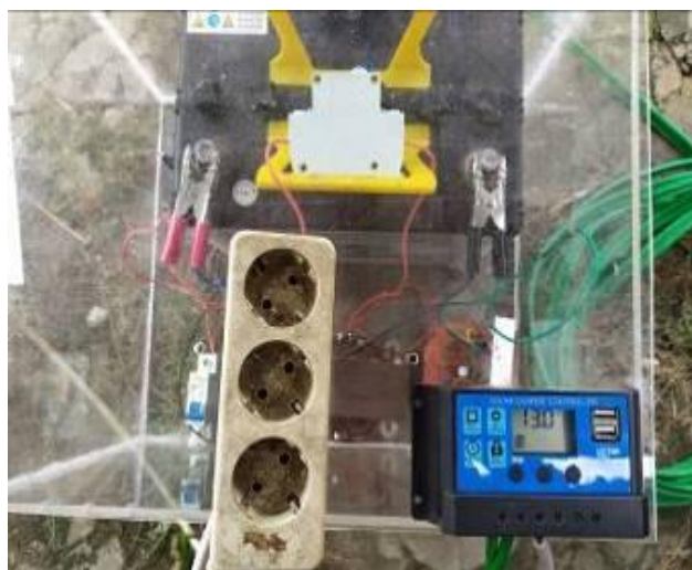
Gambar 4.6 Rangkaian Pembangkit Listrik Tenaga Surya
