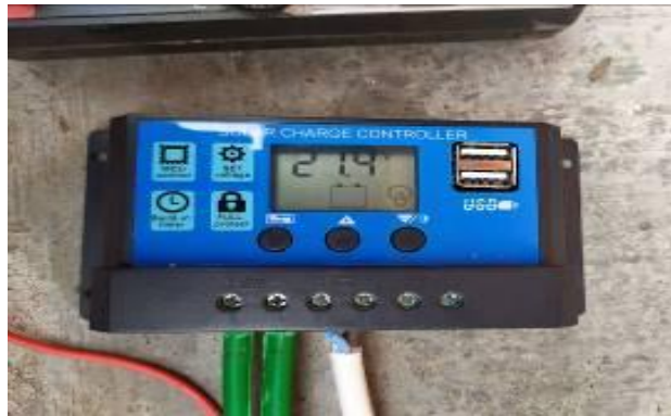
Gambar 4.8 Tegangan yang dihasilkan dari panel surya yang terukur solar charge controller
