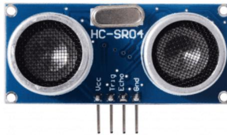
Gambar 2.6 Bentuk fisik sensor ultrasonik hc-sr04
