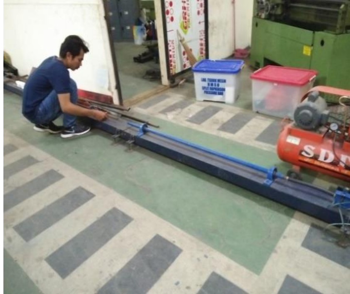
Gambar 3.16 Pemasangan besi baja karbon
