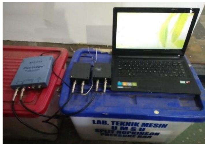
Gambar 3.20 Pemasangan Output Oscilloscope Pada PC (laptop)
