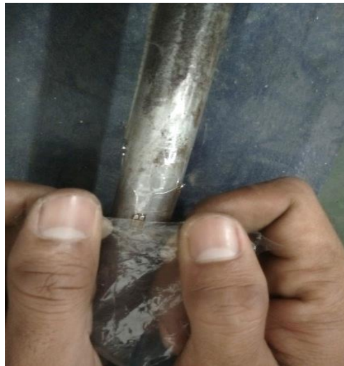
Gambar 3.14 Pemasangan strain gauge
