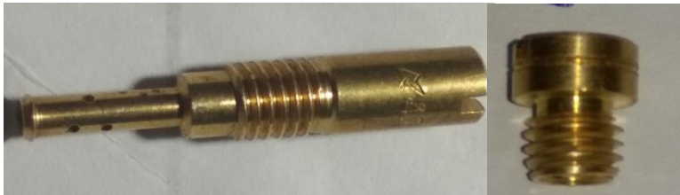
Gambar 3.4: Pilot jet dan main jet variasi dua dengan nomor 42 dan 85.
