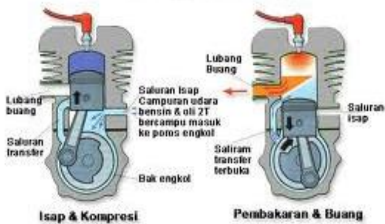
Gambar 2.3: Prinsip kerja motor 2 langkah.
