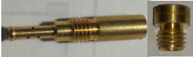
Gambar 3.3: Pilot jet dan main jet variasi satu dengan nomor 38 dan 80.
