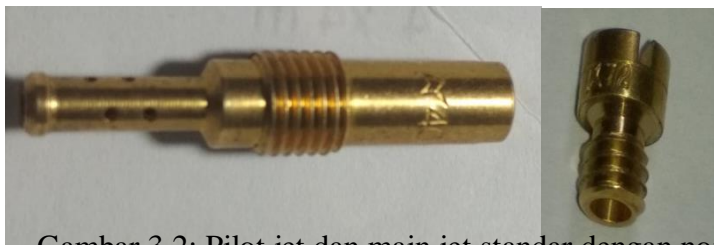
Gambar 3.2: Pilot jet dan main jet standar dengan nomor 40 dan 72.
