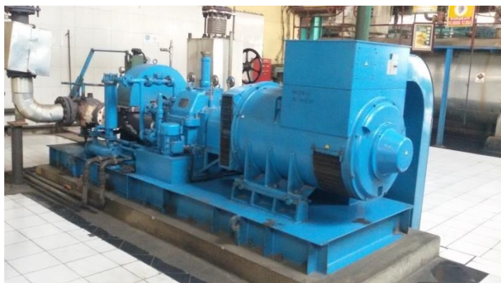
Gambar 2.27 Turbin Uap No. 2 Berkapasitas 1000 kVA
